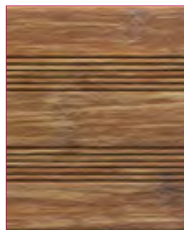
Gereinigt mit Silizium-Carbid-Besen und elephant® Reiniger
