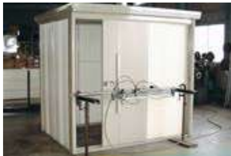
Schiebetür in Dauerbelastung (20.000 Durchläufe)
