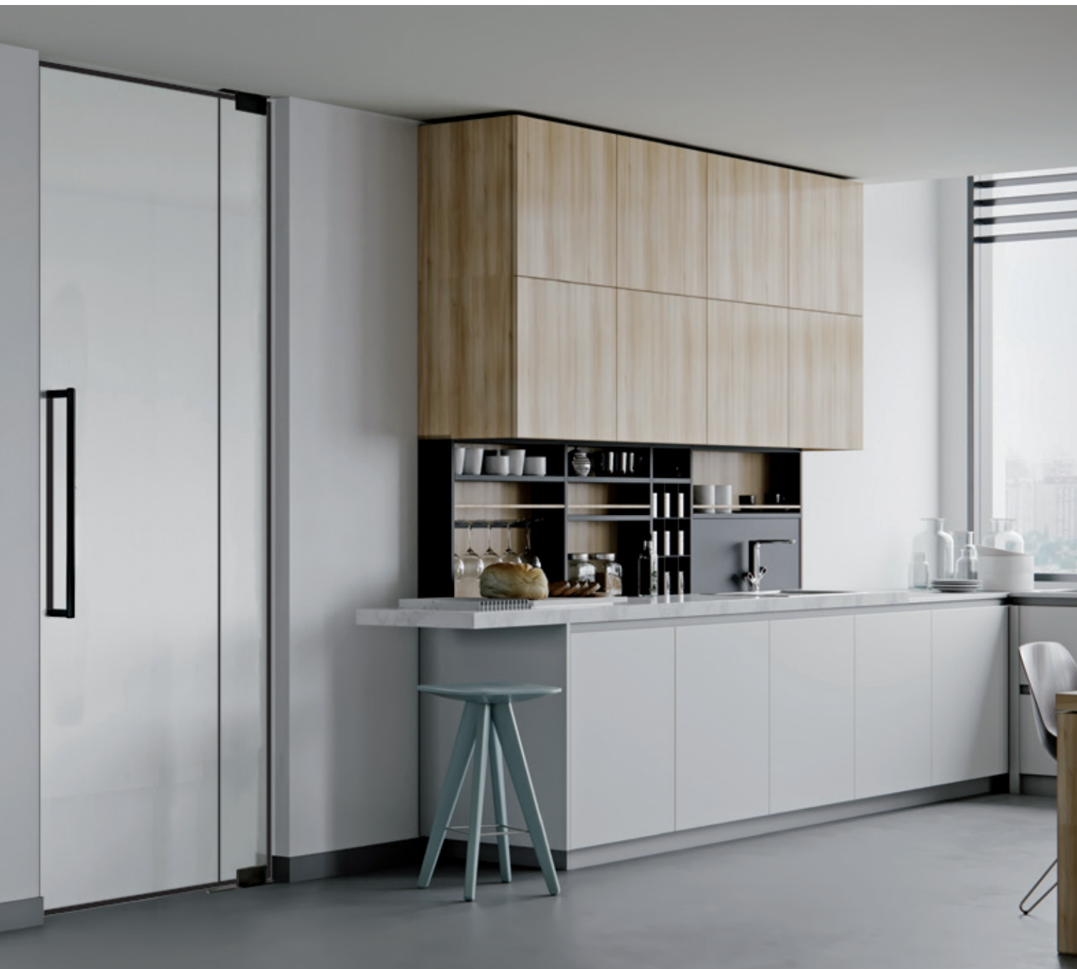
cubus 17 – BLACK|LINE, keramischer Digitaldruck | auf ExtraWeiß | Motiv matt schwarz | 1-flügelige Ganzglaspendeltür, geschosshoch | Hydraulik-Eckbeschlag – BLACK|LINE | Griffstange Uniquin – BLACK|LINE
