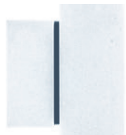
Türzarge mit Glastürband (Bei Holztüren kommen verdeckt liegende Bänder zum Einsatz – bauseits. Tectus 340 3D oder BaSys)
